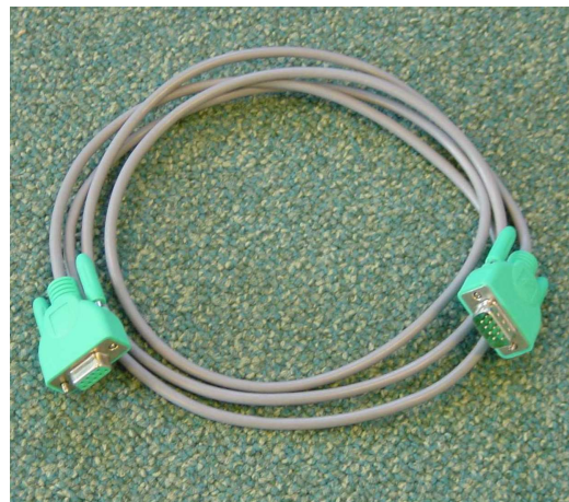
Figuur 6 RS 232 kabel voor verbinding van de TRD 10 met een PC (optioneel).
